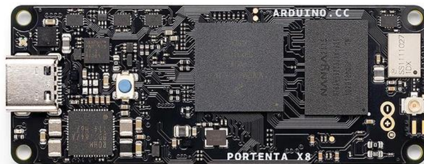
FIGURE 4: ARDUINO PRO PORTENTA X8 SOM – 66 MM X 25.4 MM
